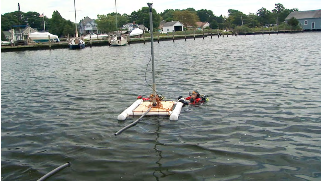
Figure 2-1: EM Floating Platform
